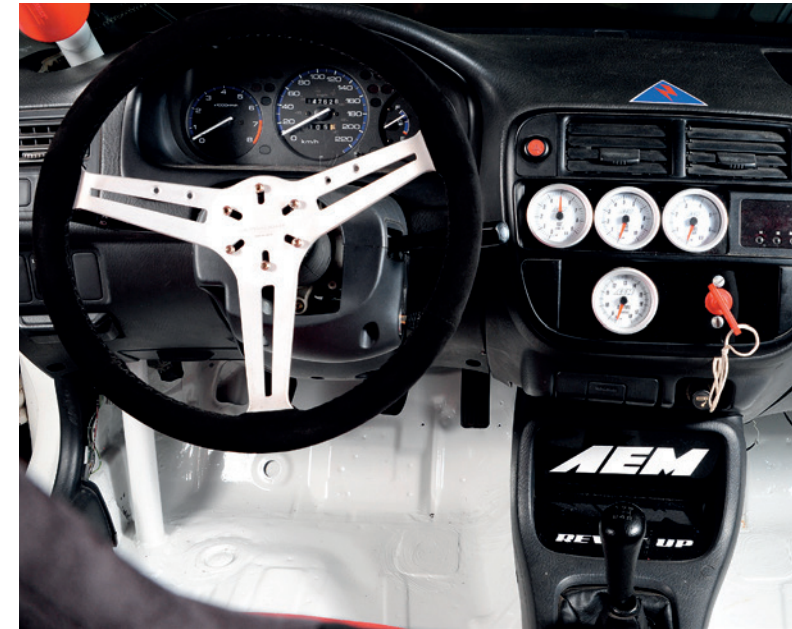
Mostradores AEM orientam o piloto na hora da corrida, o volante Shutt Ultralight substituiu o pesado volante original. A carroceria foi para São Paulo (SP) receber a gaiola na 4D
